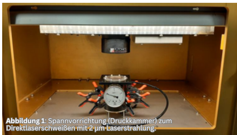
Abbildung 2: Modell einer Spannvorrichtung (Druckkammer) zum Direktlaserschweißen mit 2 µm Laserstrahlung.
