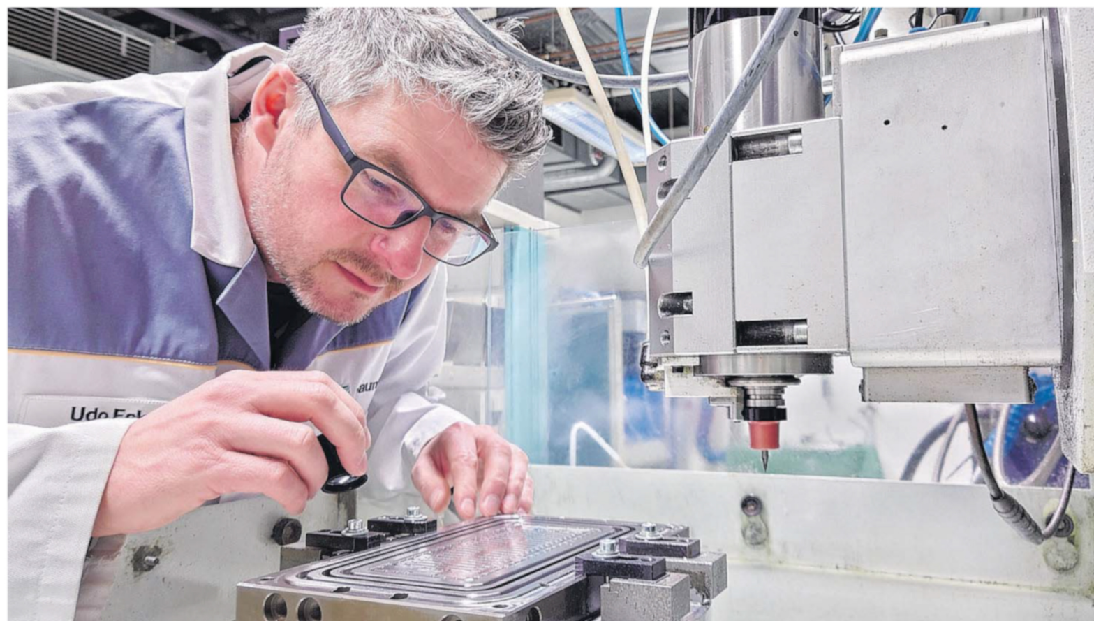
Forschung für das Mini-Labor der Zukunft: Udo Eckert vom Chemnitzer Fraunhofer-Institut IWU zerspannt mit speziellen Werkzeugen Mikrostrukturen auf einem Formeinsatz. Diese werden später mit einem Kunststoff ausgegossen und als Analyse-Chip genutzt.
